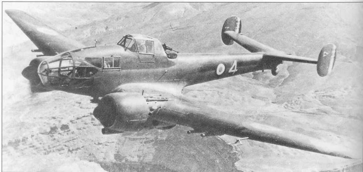
Photo très connue mais très belle d'un Potez 63.11 dans le ciel d'Afrique du Nord. Remarquez l'armement puissant de 4 mitrailleuses vers l'avant en dessous des ailes (DR)
