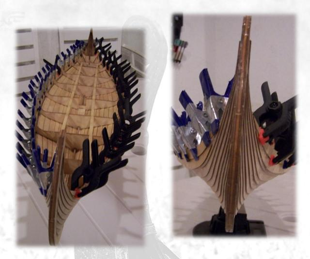
Acabado de colocar todas las tracas del casco, ahora solo falta poner la roda y el codaste en madera ya que vienen en el kit de plástico.
