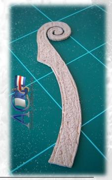
Usando una fresa cónica y otra recta de 0,8 de la dremmel he ido realizando el dibujo, para la roda con la cabeza de la serpiente y para el codaste la cola de la serpiente...
