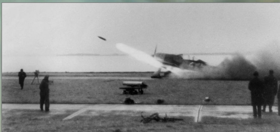
Launching tests of WGr. 21 installed on Fw 190A ( www.deutschlufwaffe.de )
