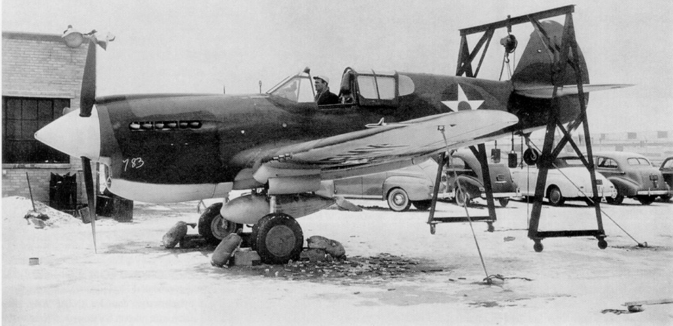
P-40E-1 (41-24783) przygotowywany do oddania do służby, prawdopodobnie w AVG. Pod kadłubem zbiornik dodatkowy o pojemności 52 US gal., 4 lutego 1941 roku.
